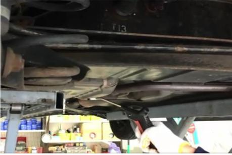
全ての窓を閉めてから、下廻り洗浄後、タイヤを外しリフトで上げる。エアブローで水滴を飛ばす。汚れていない場合はエアブローだけでほこり、砂等を飛ばすのも可能。水で濡らした雑巾で汚れた部分を拭いても可能。
