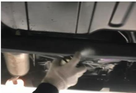
マフラー等付着を望まない所はマスキングするか段ボールを片手に持って隠しながら15~20cm必ず離して吹き付けて下さい。主にフレーム、サスペンション（鉄部分）、接合部分に吹き付けて下さい。プラスチック、ゴム部分に付着しても悪影響はありません。防錆効果を高めたい時は乾燥させて再度塗布して下さい。
